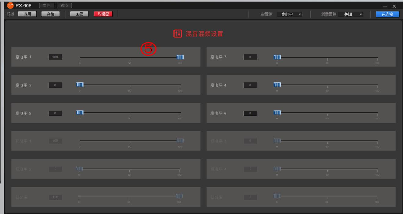
b. 同理，也检查一下CH2输出通道的输入配置情况，点击【CH2】按钮激活CH2输出通道的配置模式(见图⑥)，再点击【混音混频】按钮查看。如下图⑦，可知CH2输出通道当前对应的输入通道是高电平2，只要把高电平2的输入线接上车载音源的前置右声道扬声器输出即可。
