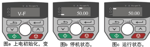
图a 上电初始化，变频器显示控制模式 图b 停机状态，显示面板操作 图c 运行状态，显示正转运行
