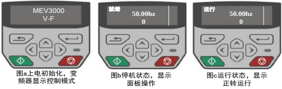
图 4-2 变频器初始化、停机、运行状态时的显示
