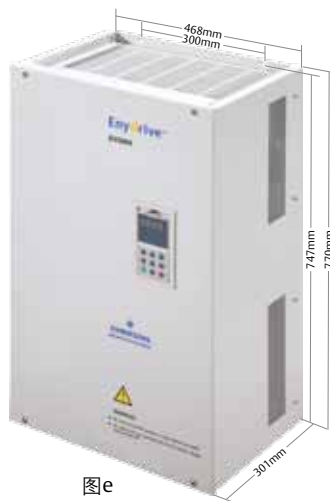
图e 75kW ~ 110kW 重量: 50kg/90kg 安装孔径: 10mm
