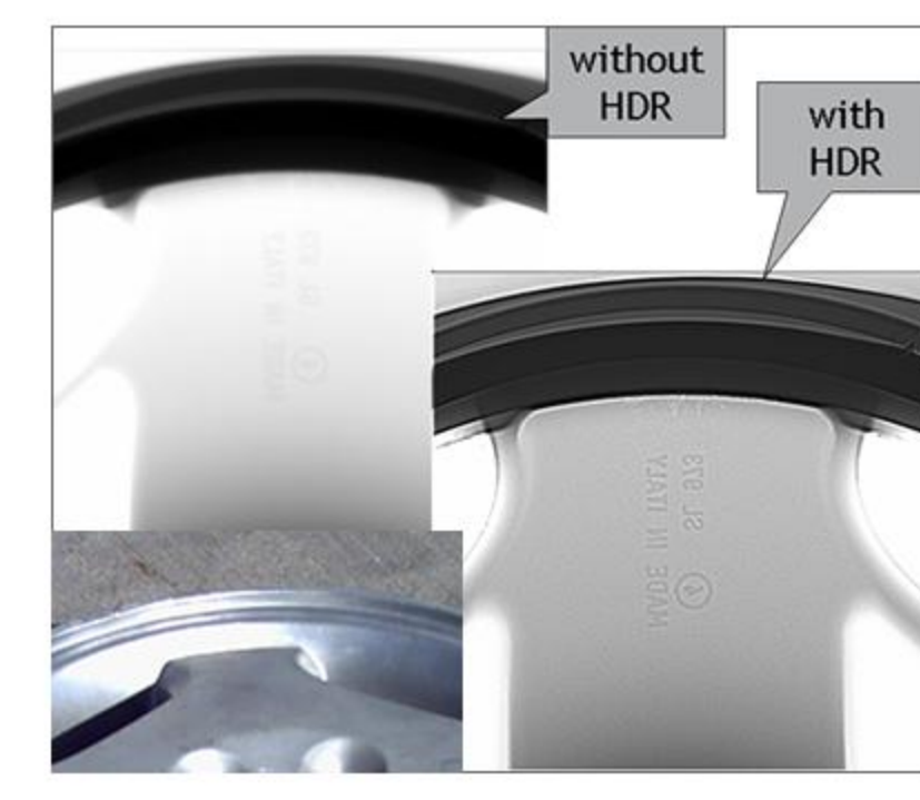
使用HDR，小缺陷的探测能力得到增强和提高，从而使得传统的视觉检测变得更加可靠和易判定
