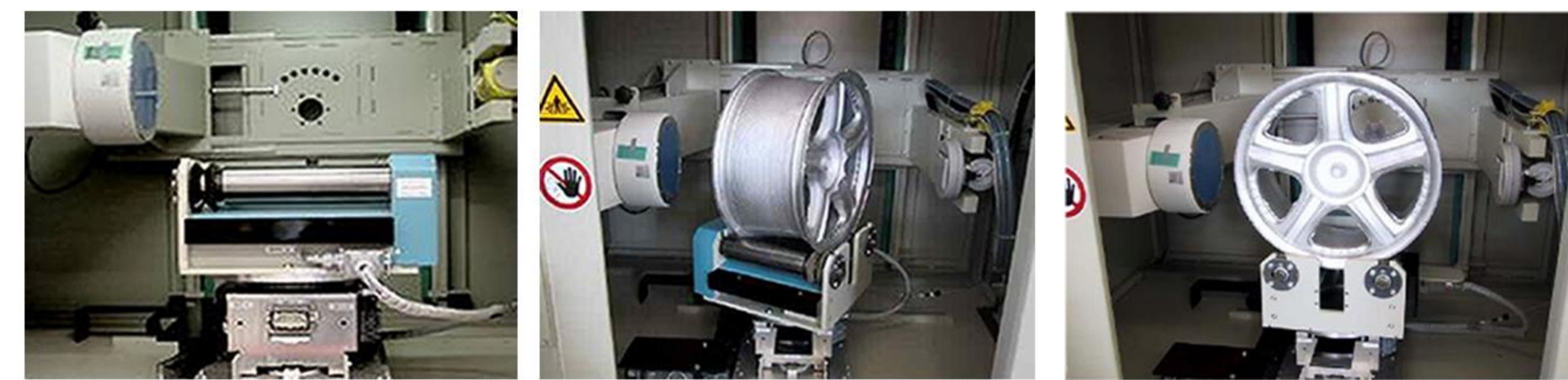
铝轮毂检测运动系统动作示意
