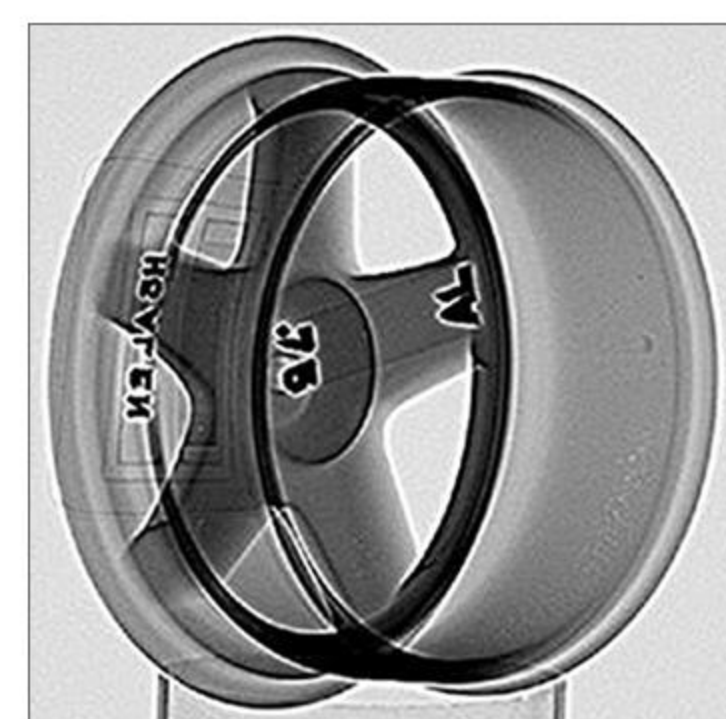
使用YXLON ASD数字平板探测器及使用HDR滤镜的高动态范围实时成像效果
