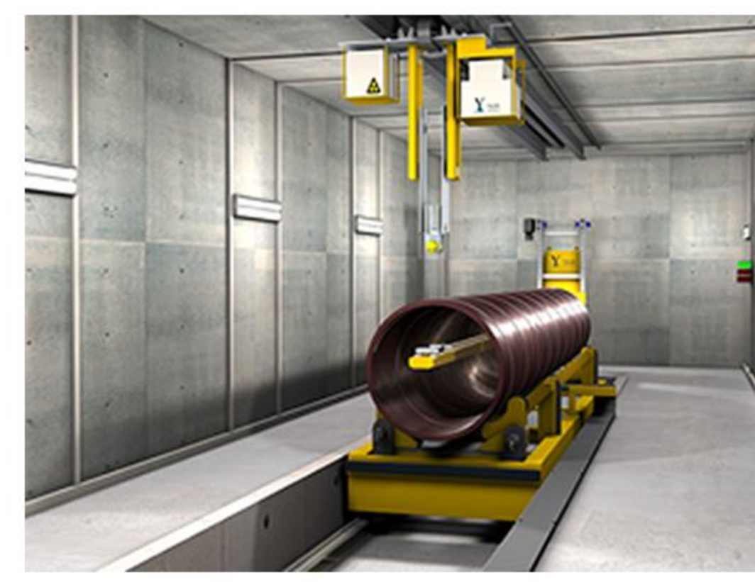
钢管拍片及实时成像检测系统
