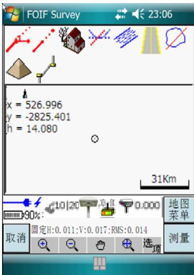
电力线放样单击屏幕中间地图区，则在上方出现测量地物选项，待移动站固定后即可进行电力线的测量工作
