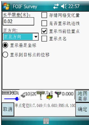
参考线放样选项设置。是否存储网格变化量、是否显示轨迹线，当前位置点，点名，垂足坐标，到目标点的距离，选择正方向和水平限差。
