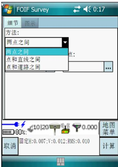
提供三种距离计算的方法，包括两点之间的距离计算、点到直线和点到道路之间的距离。并可以通过图示查看示意图。两点之间计算出平距，点到直线和点到道路之间的距离可以算出平距和垂足坐标。
