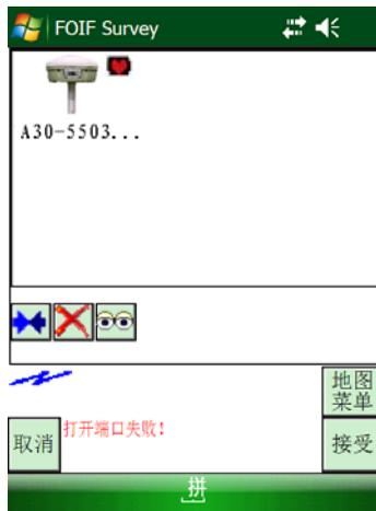
设置“绑定”后主机右上角出现红色圆点，点”接受”即可连接主机
