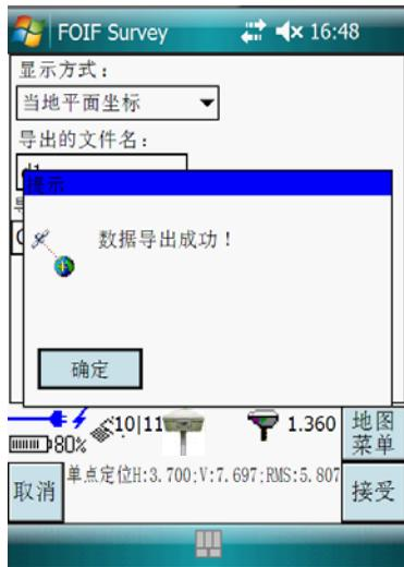
选择显示方式、导出的文件名和导出的文件类型→接受即可。软件会把成果的格式转换为文本格式，导出在手簿内存中，可通过同步软件将文件复制到电脑中编辑图形。
