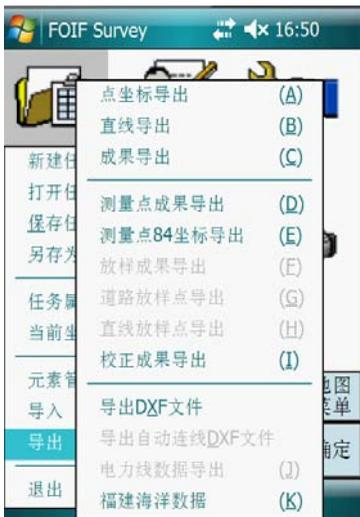
包括点坐标导出、成果导出、测量点成果导出、放样成果导出、校正成果导出、导出 DXF 文件、电力线数据导出、福建海洋数据导出八个选项，下面逐一介绍它们的功能。
