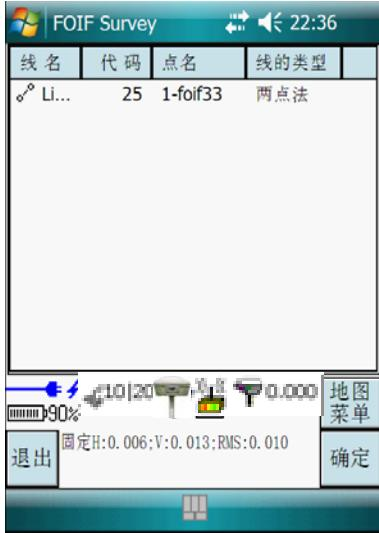
常用于电杆排放、道路放样等。根据界面的导航信息可以快速到达待定直线，方便快捷。线放样有直线放样和直线库放样
