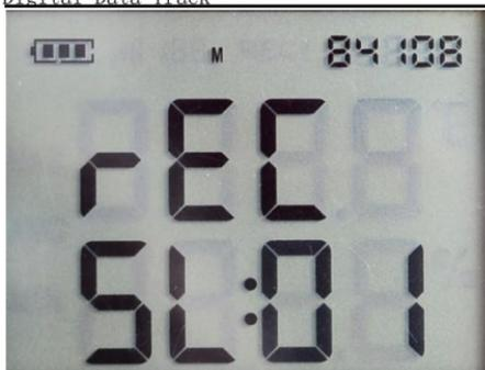
2.切换显示操作：数据显示状态下点按
