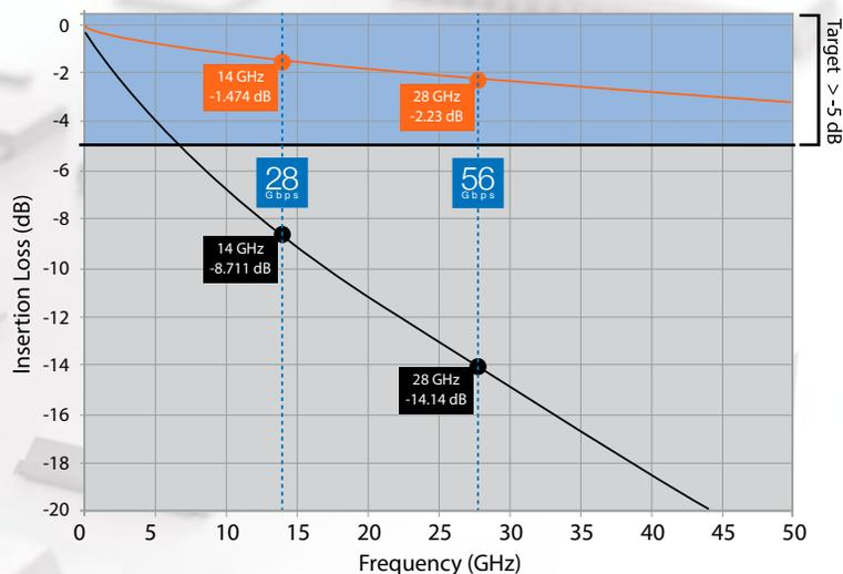
30 AWG 100 Ω Low Skew Twinax Cable
