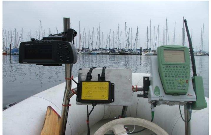
Sonar M8 是用于勘测船上的半固定式设备 Sonar Mite 的不同版本。Sonar M8 与其它同类设备的主要区别是体积更小，没有内置电池。SonarM8 的内部装置包括一个调节器，该调节器接受宽范围的直流输入电压，从 7 伏到 32 伏。
