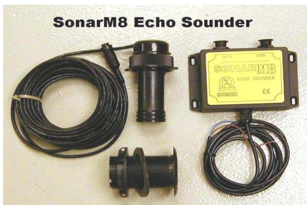
SonarM8 设备运用了与 SonarMite 同样的小巧型传感器技术。除了使用 DSP 技术的高度可靠的底部跟踪运算法则，该系统还产生与深度测量相关的高质量价值。SonarM8 “前端”的软件可以用在使用 Windows 操作系统的从笔记本到台式机的一系列设备上。SonarM8 具有全身 DT800 塑料外壳传感器是半固定式安装。齐平的顶置传感器与便携式 P66 传感器相比，因其棱角更少，所以具有低噪音的声纳回声
