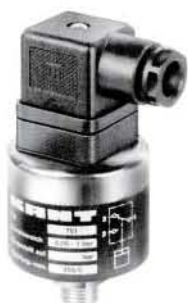
701型真空压力开关, 转换开关 使用插头为PG9 DIN43650 开关体材料: 铝; 连接部分材料: 铜
