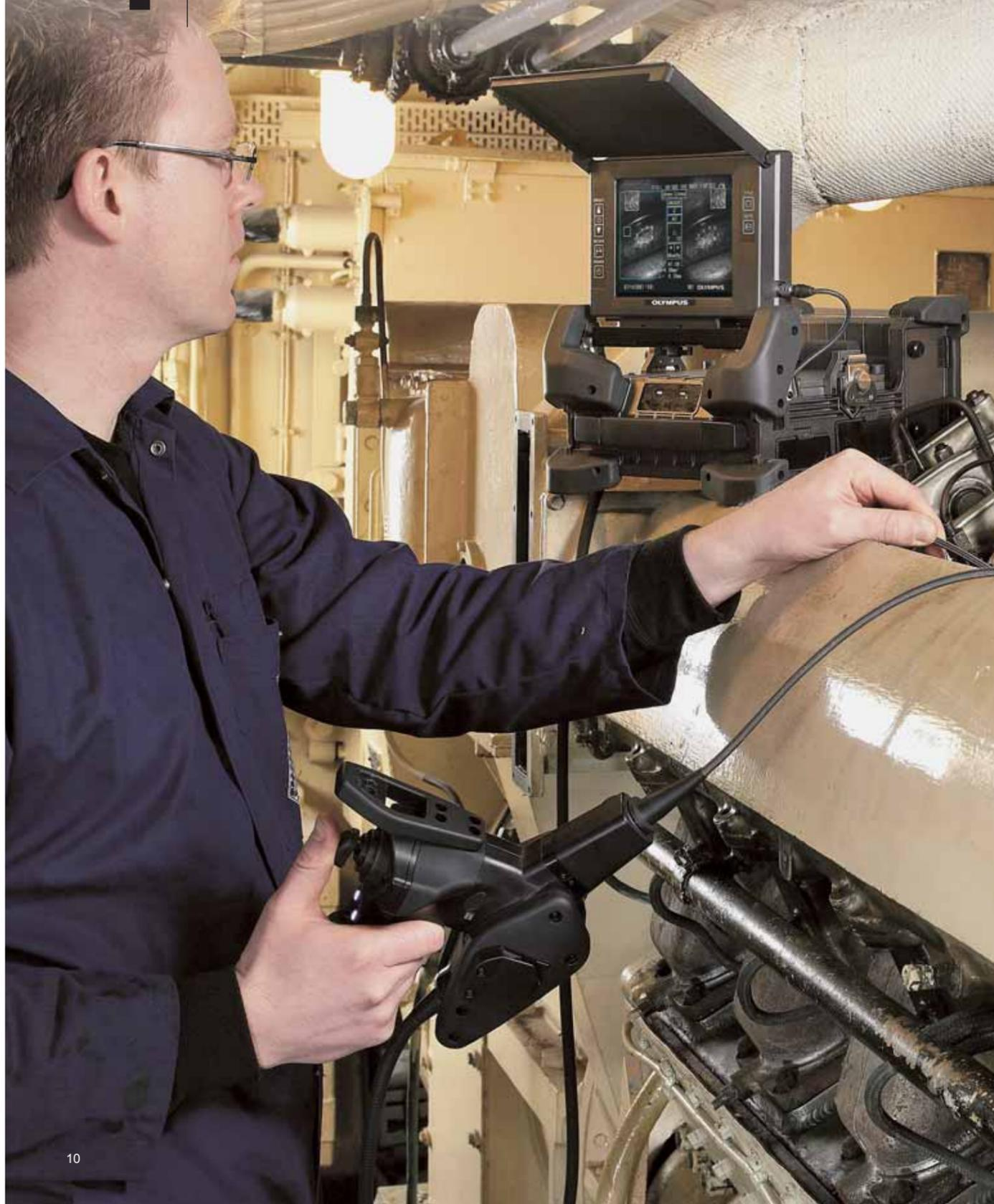
各式各样的可互换观测仪器（包括长达 18 米的插入管型号和带有内置工作通道的型号）使 IPLEX FX 能够应对几乎所有类型的检测。IPLEX FX 不仅仅是检测工具，还是一种可靠的、功能丰富的系统，能实时测量损伤并抓取外来异物。
