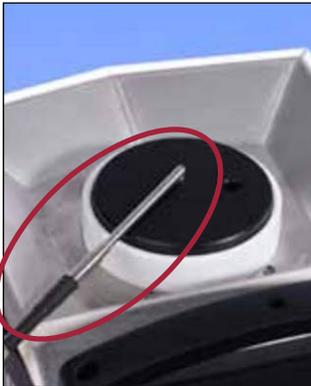
STS-200参考探头和DLC探头是特殊设计的。AMETEK可以提供形状为90°弯角的参考探头和DLC探头，这些探头在插入套管时，上端仅比套管顶部稍高。
