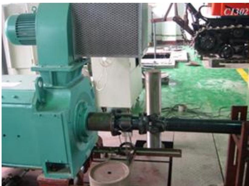
扭矩传感器在检测拖拉机输出功率试验现场
