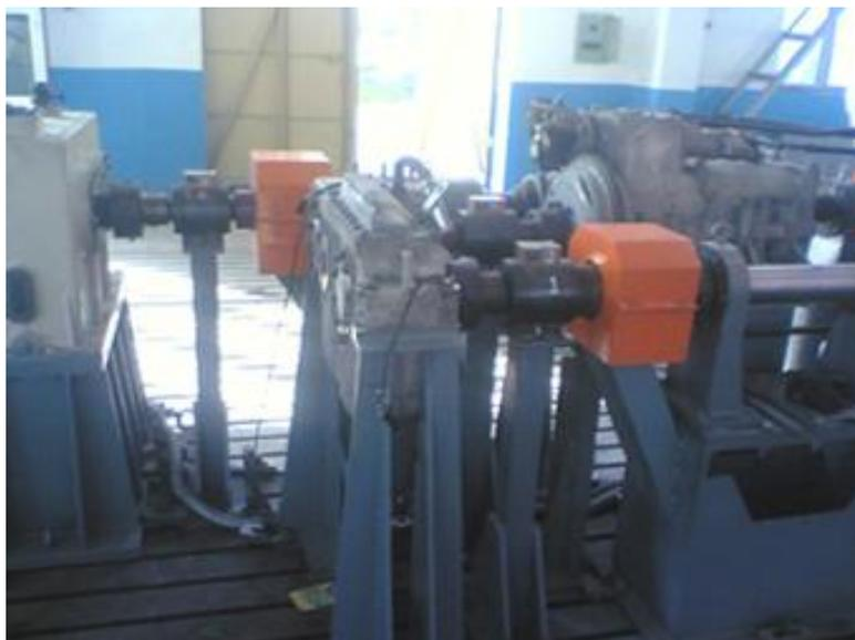
扭矩传感器在装甲车发动机测控试验系统应用现场
