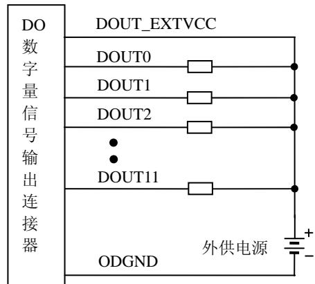
DO 输出带有锁存功能，当计算机关机或因故停机时，只要端子上的外供电源未停电，则输出将保持计算机停机前的状态，直到计算机恢复运行后发出新的输出指令为止。
