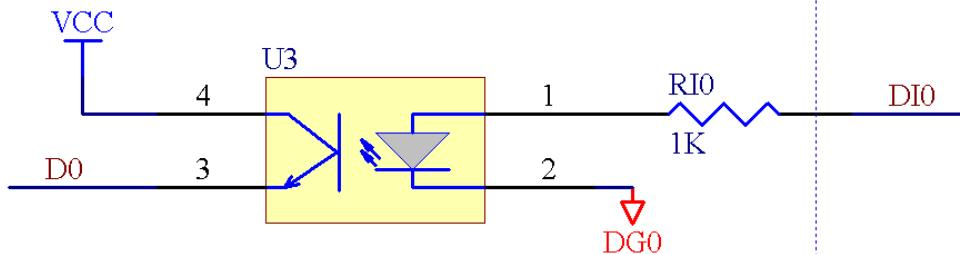
图中虚线右边的为输入信号 DI0。其工作原理为: 当 DI0 输入为低电平时, 光耦 U3 的 1、2 脚之间 (即 DI0 与 DG0 之间) 无压差, 内部无电流, 则发光二极管不发光, 无法使内部的三极管导通, 即 U3 的 3、4 脚之间未连通, 则 3 脚的输出信号 D0 为低电平; 当 DI0 输入为高电平时, U3 的 1、2 脚之间有压差, 则内部会有电流通过发光管使其发光, 使内部三极管导通, 即 U3 的 3、4 脚连通, 则 3 脚的输出信号 D0 变为高电平。
