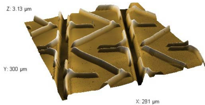
图5：一幅拼接好的AFM三维图像。这幅图（对应图4得到的拼接结果），200倍放大倍数，演示了使用Nanosurf Nanite B AFM和自动移动平台如何轻松获得高分辨率的三维数据。也演示了拼接结果是多么的严丝合缝。
