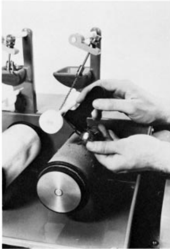
FIG. 6 Adjusting Mace on ICI Snag Tester
