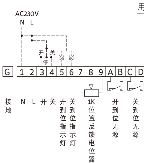
图4: 开关型执行器(型号带BDC)接线图
