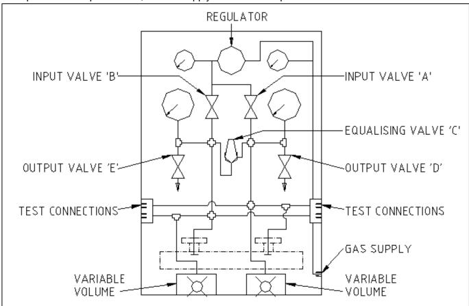
SCHEMATIC DIAGRAM OF MODEL 249T(TL)
