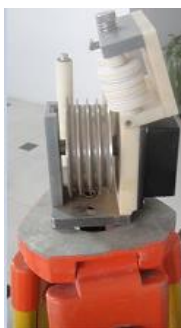
图 F1.3 深度记录装置安装
