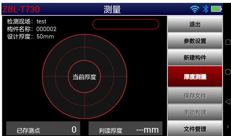
图 4.1 楼板测厚软件主界面
