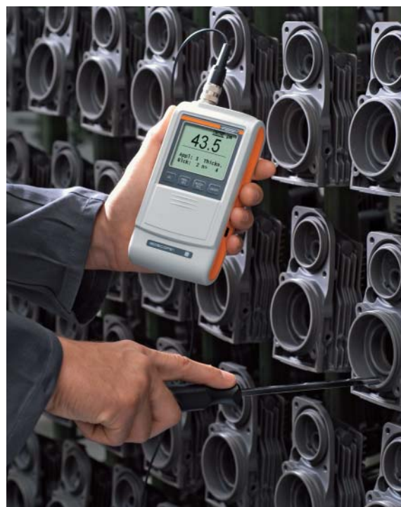
使用FAI 3.3-150探头进行测量。
