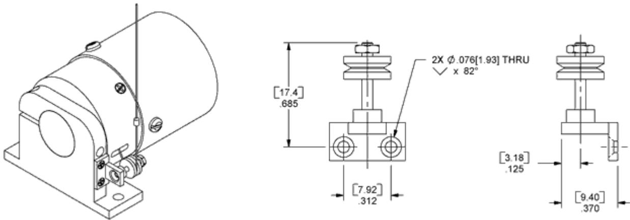
惰轮 • pn 161022 • 补偿离开中心的钢索行程(\_61/\_62) ;惰轮会缩短移动钢索的寿命 ;惰轮不推荐用于-070 和-080 弹簧 ;惰轮仅仅推荐用于 0.018-inch (0.46-mm) 直径的移动钢索 ;不包括传感器
