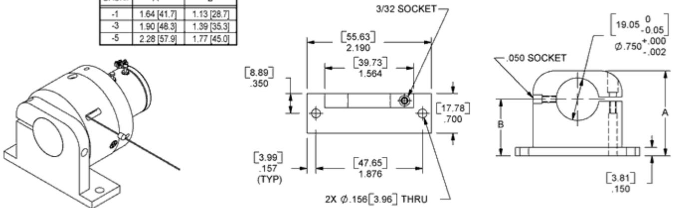
基座：通用(\_6\_) • pn 160030-\_ • 垂直安装；允许绕两个轴旋转；不包括传感器
