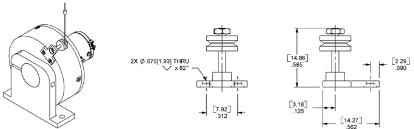
电气连接器 : MS3106F-14S-6S, 6 针, 应变消除 , 匹配 • pn 300853 • 匹配连接器 MS3106A-14S-6P
