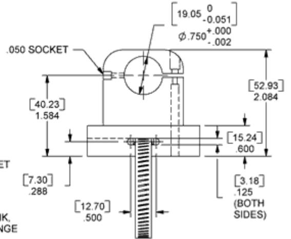
基座：通用(微型) (\_60) • pn 300460 • 垂直安装; 允许以两个轴旋转；不包括传感器
