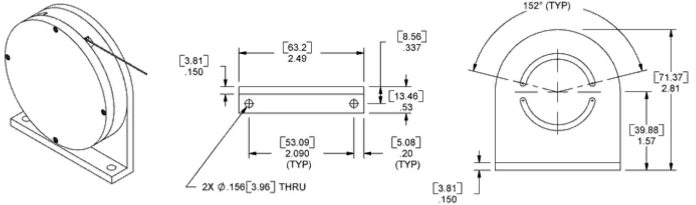
基座：磁铁(\_6\_) • pn 160005 • 对\_6\_标准和通用基座有磁性安装能力；不包括传感器；至少订货数量：10 each
