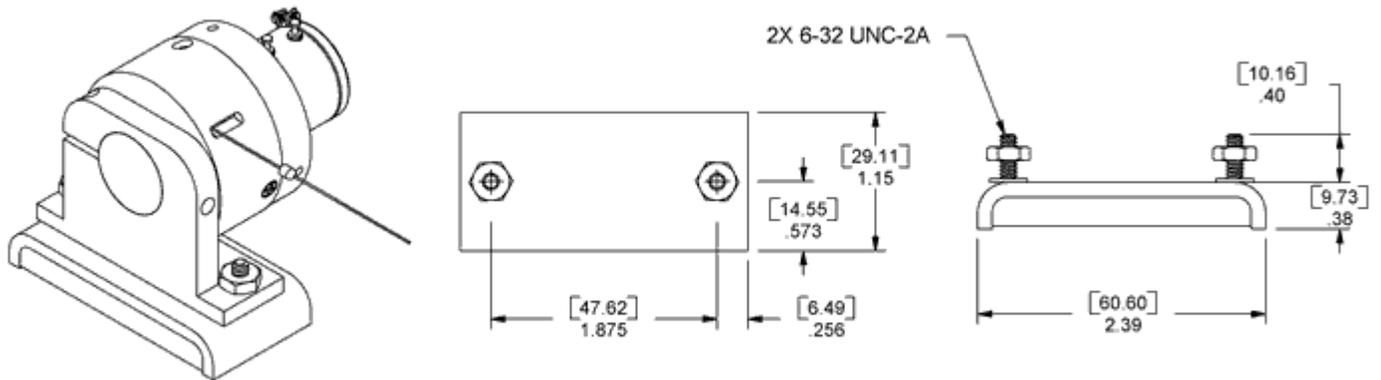
基座：标准(\_6\_) • pn 160015-\_ • 垂直安装；允许以一个轴 360°自由旋转；不包括传感器
