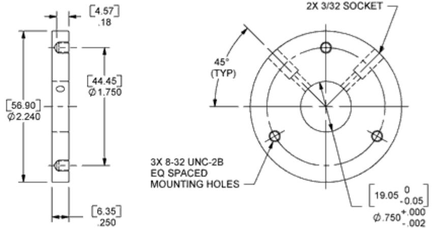
基座：大脚(\_6\_) • pn 160015-1\_ • 与基座类似；带有更宽的底部标准基座，以便有更易螺丝孔，不包括传感器
