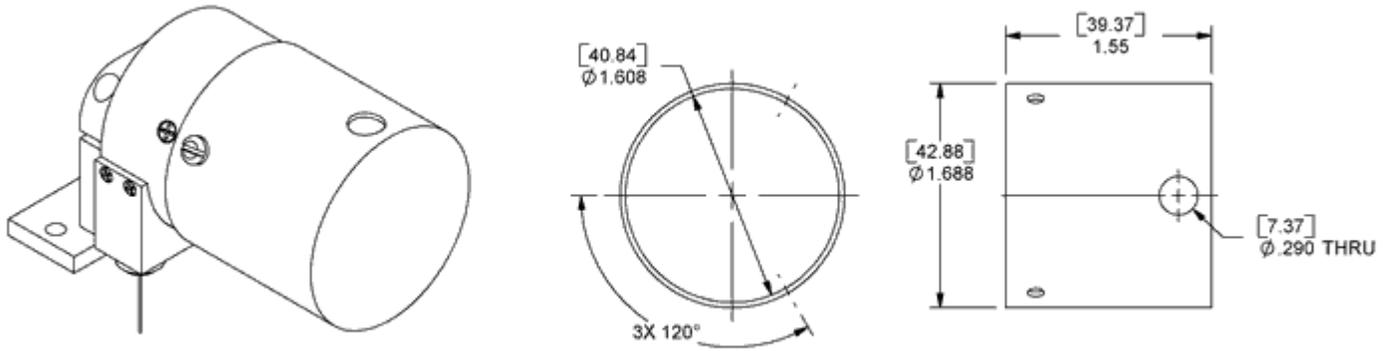
惰轮 • pn 160022 • 补偿离开中心的钢索行程(\_60) ;惰轮会缩短移动钢索的寿命 ;惰轮不推荐用于-070 和-080 弹簧 ;惰轮仅仅推荐用于 0.018-inch (0.46-mm) 直径的移动钢索 ;不包括传感器
