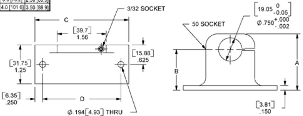
基座：h(\_60) • pn 160015-G1 • 与基座类似；带有狭槽标准的基座，用皮带夹住附件；不包括传感器
