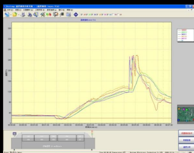
波峰焊曲线图 Wave crest weld curve chart
