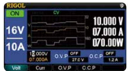
带有V/A/W当前值的实时的V/A/W波形显示
