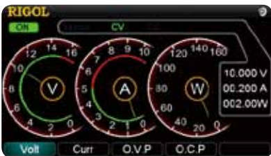
DP116A 提供了带有表盘和指针的经典显示模式同时有V/A/W当前值的实时数字显示
