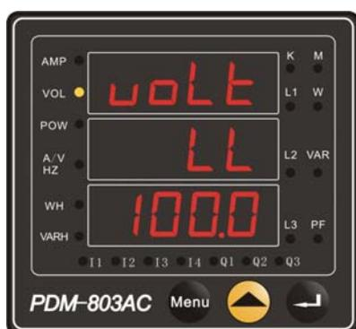
在进行电压变比设定时中间行显示的单位(HH表示为KV,LL表示为V),修改变比时最先可改的为单位,之后可改的为小数点的位置,最后可改的为数值。
