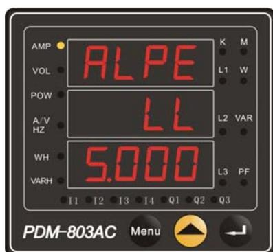
在进行电流变比设定时中间行显示的单位(HH表示为KA,LL表示为A),修改变比时最先可改的为单位,之后可改的为小数点的位置,最后可改的为数值。
