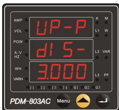
此参数为有功功率越上限判定的软开关。只有当此开关开启时（即该项使能 **ENbL**），装置才进行针对有功功率越上限检查。不启动开关可将中间行设置为 **dl 5-**。越限数值可设定。
