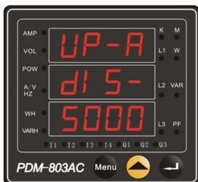
此参数为电流越上限判定的软开关。只有当此开关开启时（即该项使能 **ENbL**），装置才进行针对电流越上限检查。不启动开关可将中间行设置为 **dl 5-**。越限数值可设定。
