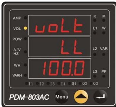
例 2：修改电压变比（把电压变比为 100.0V 修改为 06.00KV）。
