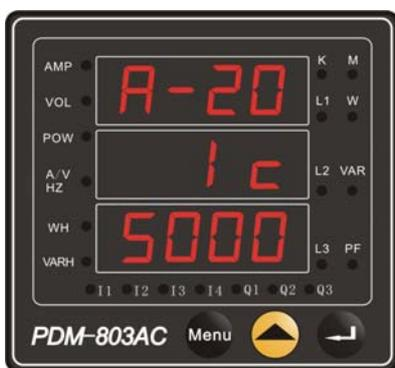
可编选定项 (IA、IB、IC、3I0、VAN、VBN、VCN、VAB、VBC、VCA、WAT、VAR、SHIZ、PF、FREQ) 电量为模拟量 DC4~20mA 输出。选定项电量为 0 时对应输出 4mA；对应 20mA 的数值在最下行显示并可设定。
