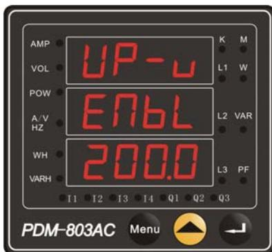
如图所示：电压越上限的上限数值修改完毕，并已改为使能。按
