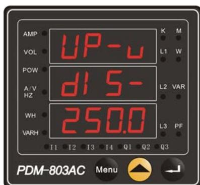
此参数为电压越上限判定的软开关。只有当此开关开启时（即该项使能 **ENbL**），装置才进行针对电压越上限检查。不启动开关可将中间行设置为 **d15-**。越限数值可设定。
