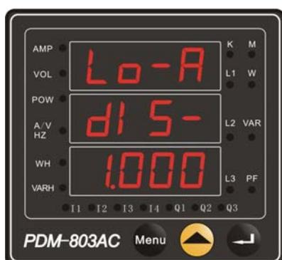
此参数为电流越下限判定的软开关。只有当此开关开启时（即该项使能 **ENbL**），装置才进行针对电流越下限检查。不启动开关可将中间行设置为 **dl 5-**。越限数值可设定。
