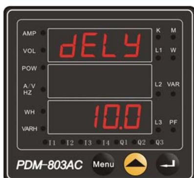
越限判定延时时间是为了减小误报功能的，当设定越限功能后进行越限判断时，要求被测值在判定延时时间内持续保持越限状态后输出。设定级差为 0.1 秒。
