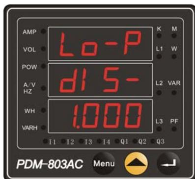
此参数为有功功率越下限判定的软开关。只有当此开关开启时（即该项使能 **ENbL**），装置才进行针对有功功率越下限检查。不启动开关可将中间行设置为 **dl 5-**。越限数值可设定。
