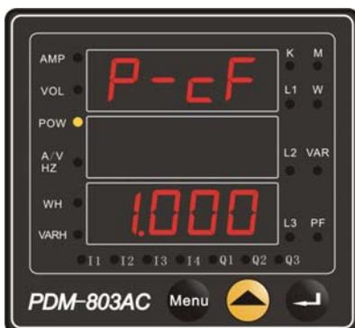
功率调整系数用于功率精度达不到要求时，调整功率的测量结果。装置出厂时不需要调整此系数，只有当装置运行多年后，可能需要修改。(0.500~2.500)
