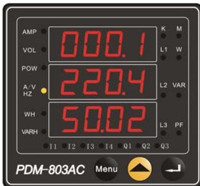
屏幕显示零序电压、三相相电压平均值和频率
