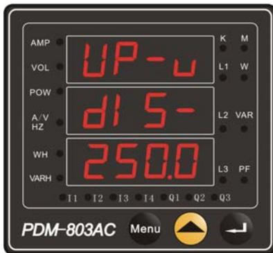
例 3: 将电压越限的门槛上限数值 250.0 修改为 200.0, 并将该功能修改为使能。
