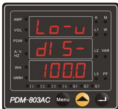
此参数为电压越下限判定的软开关。只有当此开关开启时（即该项使能 **ENbL**），装置才进行针对电压越下限检查。不启动开关可将中间行设置为 **d15-**。越限数值可设定。
