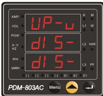
如图所示: 进入越上限有效状态, 按
