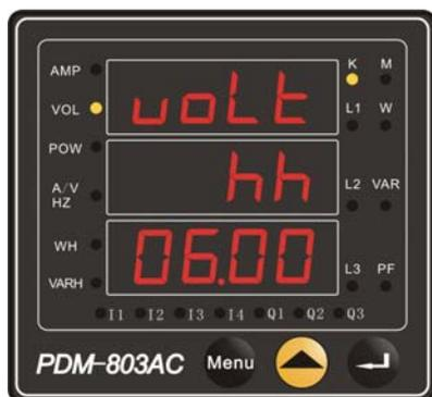
如图所示：电压变比修改完毕。
