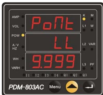
在进行功率量程设定时中间行显示的单位(HH表示为MW,LL表示为KW),当功率设定为“HH”表示MW时,相应的有功电能显示为MWH,无功电能显示为MVARH。修改变比时最先可改的为单位,之后可改的为小数点的位置。
