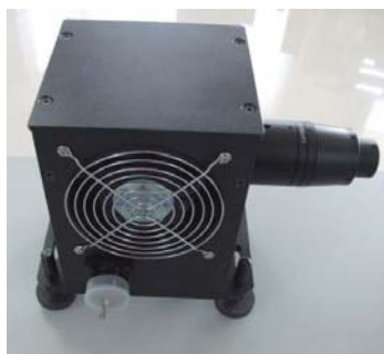
溴钨灯光源室
