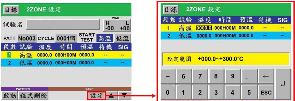
6-3-8. 啟動：試驗程式設定完成後，且確定運轉設定中之設定符合需求時，可點擊此鍵來直接啟動運轉。
