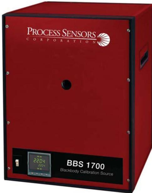
黑体校正源BBS1700具有+0.99的辐射率和25mm (1")的孔径。
