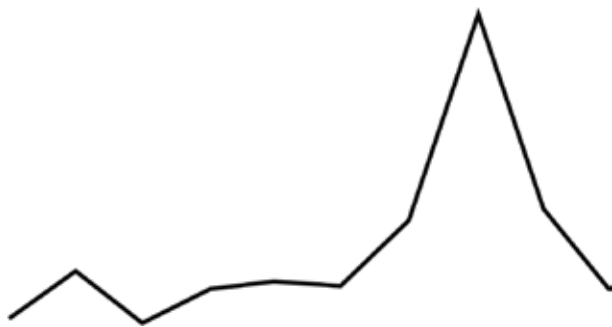
图 2-20. 取样检波模式使用 10 个点显示图 2-17 中的信号
