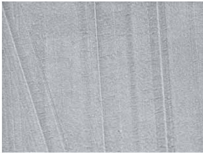
低加速电压图像 通过低加速电压图像可以观察细微结构，在高加速电压图像中，因溶于其中而不能观察。
