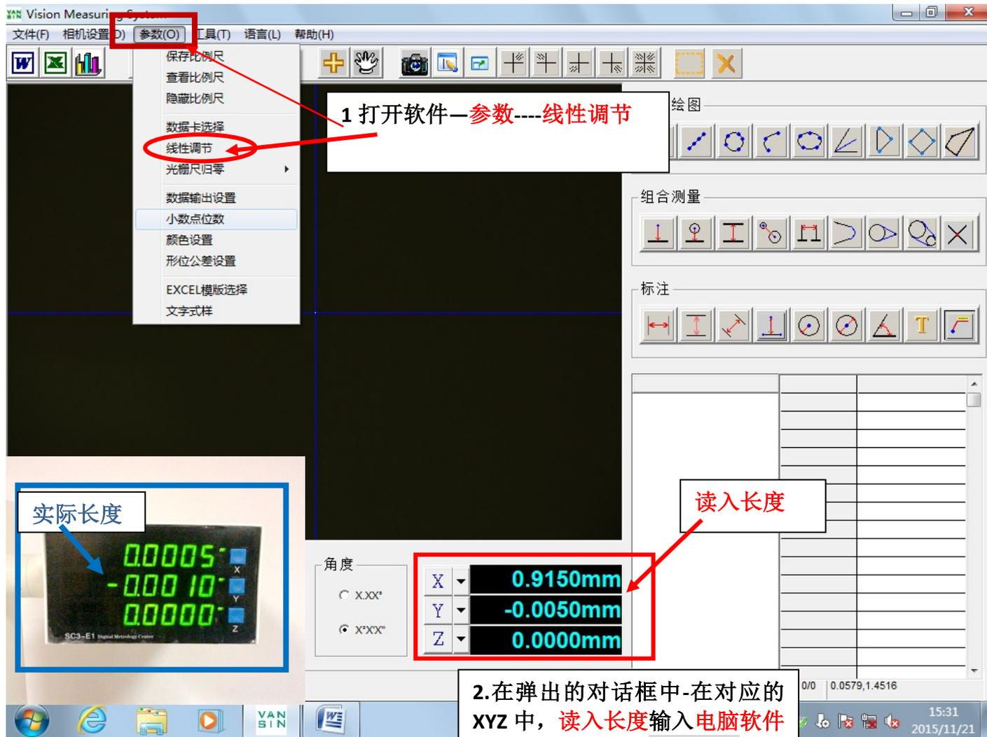
2.在弹出的对话框中-在对应的XYZ中, 读入长度输入电脑软件界面显示的数值, 实际长度输入机台数码表显示的数值, 最后确认即可
