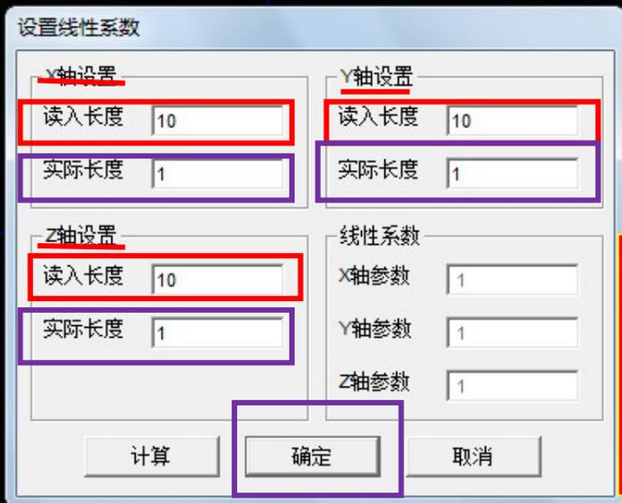
备注: 通常情况下, 读入长度和实际长度相差 10 倍, 按照图示读入长度输入 10, 实际长度输入 1, 确认即可
