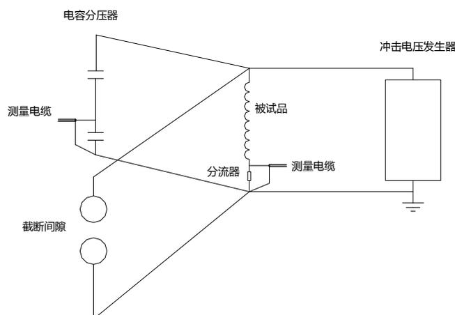
2、绝缘子类容性负载冲击电压试验的设备布局及接线说明：
