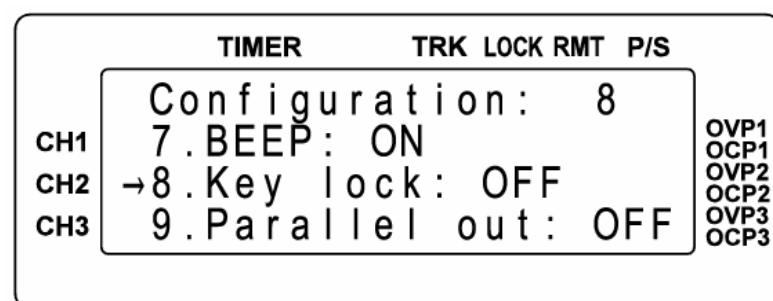
9. Parallel out：並聯輸出。初始值為 OFF；按一下飛梭旋鈕之後，狀態更改為 ON。跳出 Config(設定)畫面之後，此時的 CH1 & CH2 內部正端相連、負端相連，原本任一 CH 可輸出 30V/3A 的電流，如今已可以輸出 30V/6A。
