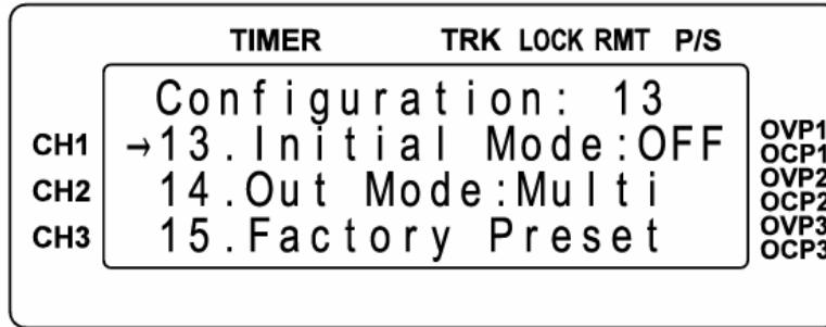
14. Out Mode：輸出模式。初始值為 Single；按一下飛梭旋鈕之後，狀態更改為 Multi。Single 為單一組輸出模式。Multi 為三組輸出模式。選擇 Single；跳出 Config(設定)畫面之後，當按下 ON/OFF 鍵，一次一組輸出。選擇 Multi；跳出 Config(設定)畫面之後，按下 ON/OFF 鍵，一次三組輸出。
