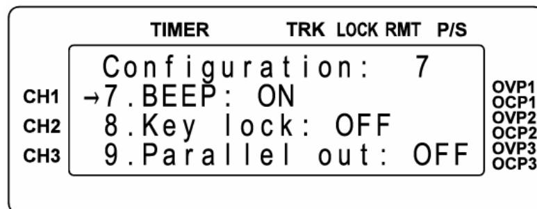
8. Key lock : 按鍵鎖功能。初始值為 OFF；按一下飛梭旋鈕之後狀態為 ON，整個指令無法按鍵輸入，要解除狀態按住飛梭 + CLEAR 鍵既可。
