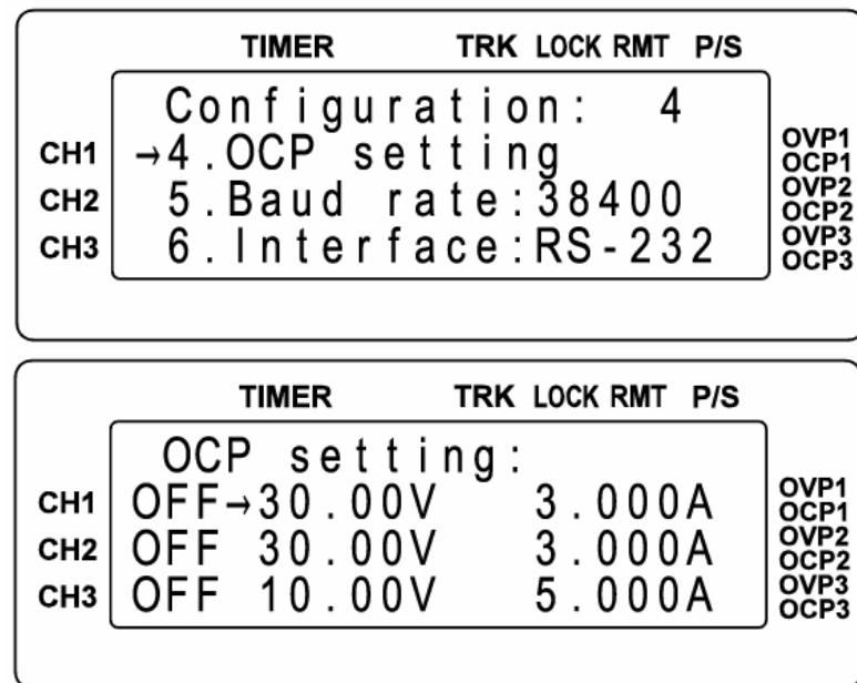
5. Baud rate : 傳輸速率。RS232 的 Baud rate 速率選擇，有 1200、2400、4800、9600、19200、38400。按一下飛梭旋鈕來選擇速率。
