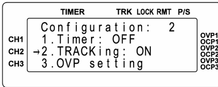
3. OVP setting：過電壓保護。按一下飛梭旋鈕之後，進入 OVP 的設定畫面。
