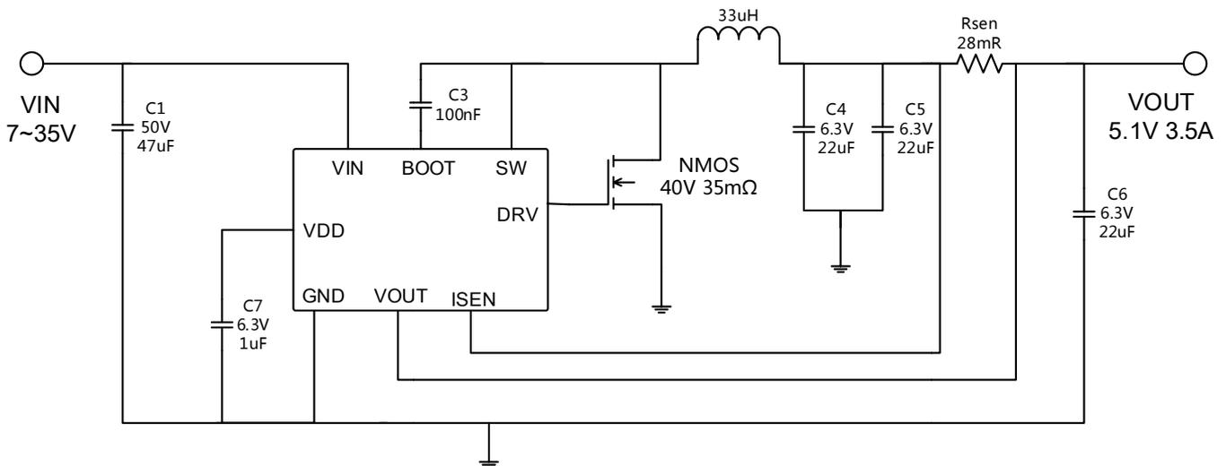
图 1 同步降压模式应用线路图
