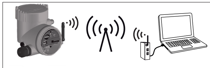
插图. 51: 通过移动网络来传输传感器的测量值并为传感器远程设置参数
