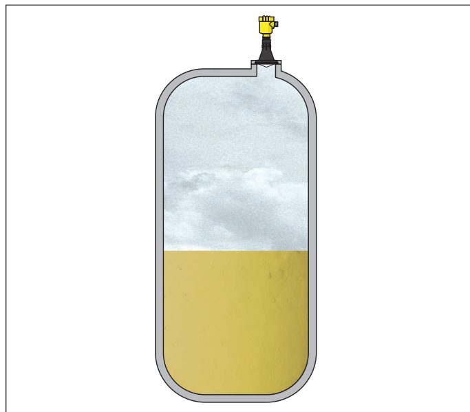
插图. 26: 用 VEGAPULS 61 在一个酸槽中测量液位
