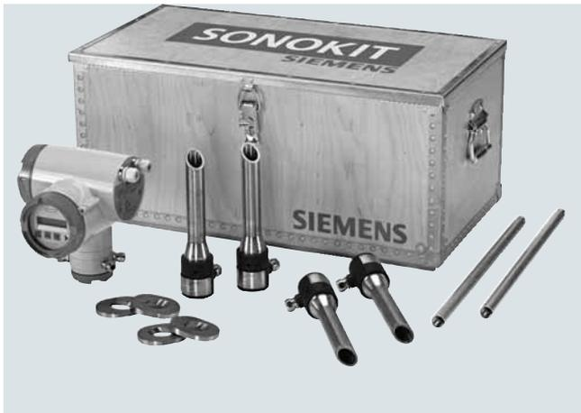
SONOKIT 是基于时差法的超声流量计，在现有管道上直接安装。SONOKIT 安装组件包括各种必要的部件和安装单通道或双通道流量计所需的各种专用工具。此设备适合安装在空管或带压管道上而不用断流（带压安装）。关于带压安装工具的详细信息和使用说明请与西门子联系。SONOKIT 采用湿式换能器（与液体接触），这样确保了更高的测量精度。
