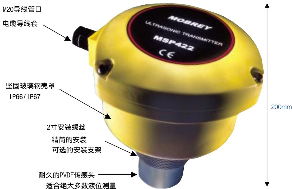
由于液位变送器带有 2"安装螺纹，所以安装时可以直接将液位变送器安装在槽罐上或者安装支架上，安装位置要垂直于液面上方。
