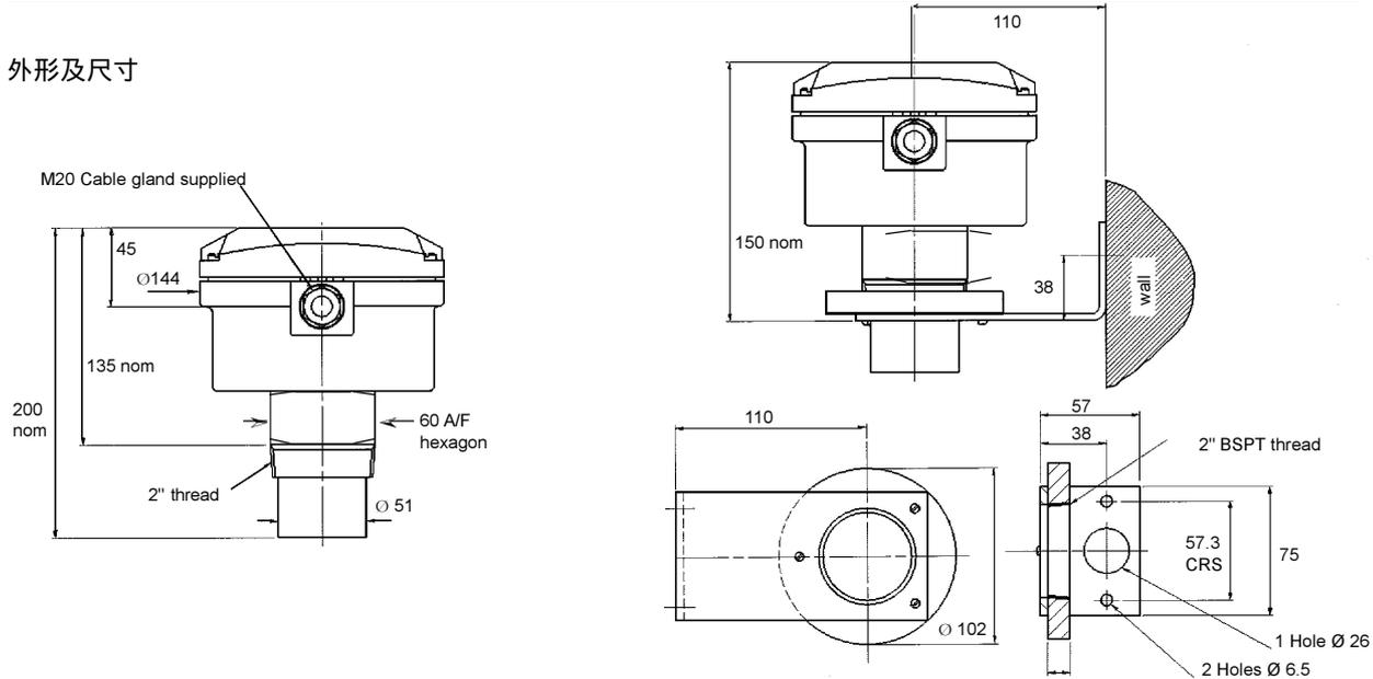
附件：MSP-BRK2，含一个不锈钢安装支架和一个 PVC 材料的带螺纹的锁紧螺母，用于墙壁安装或支架安装。
