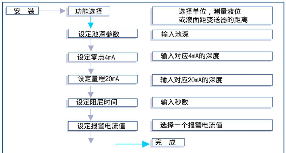
考虑到实际检测过程中，池中也许有其他设施妨碍测量，比如扶梯或者水泵会反射超声波信号，因此在 MSP422 设计中加入了假信号辨识功能，如果有假信号存在，用户可以在设定时在程序中输入“Lrn”，这样在液位变送器进行测量时会忽略该假信号。
