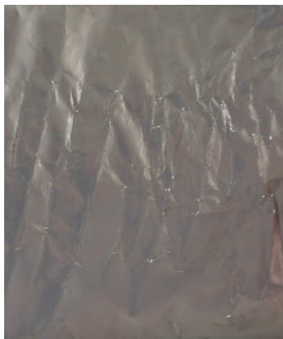
图 3 揉搓后的铝塑复合膜
