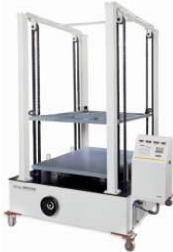
图 2 XYD-15K 纸箱抗压试验机
