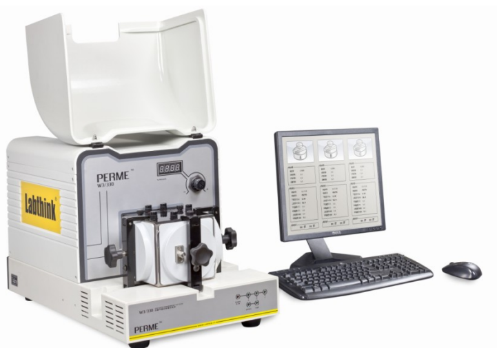
图 3 W3/330 水蒸气透过率测试系统
