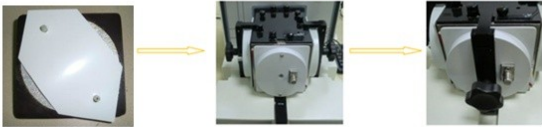
图 4 试样装夹过程
