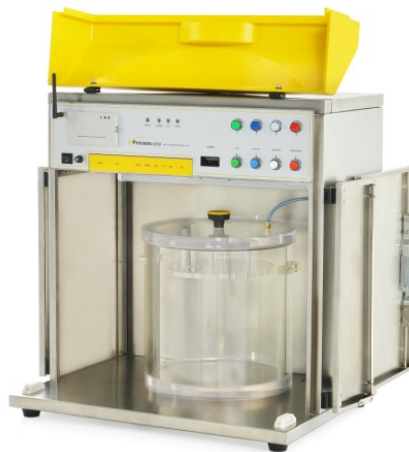
图 3 i-Process6200 密封试验仪及数据处理系统
