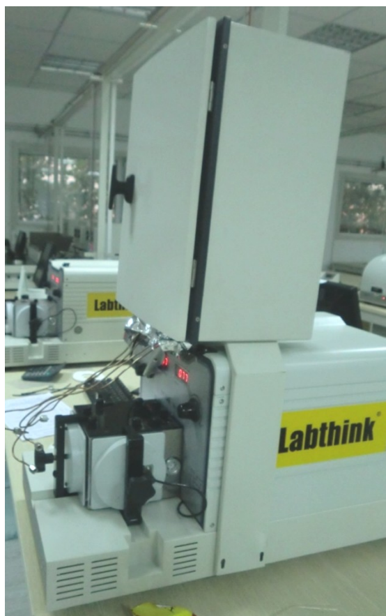
b. 带有容器测试装置的系统外观图
