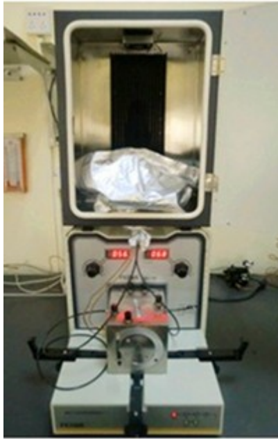
d. 将试样装夹到仪器内并密封
