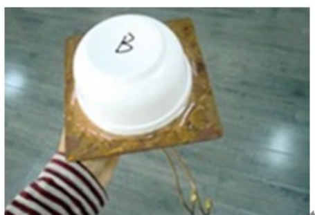
c. 将试样密封在容器封口装置上
