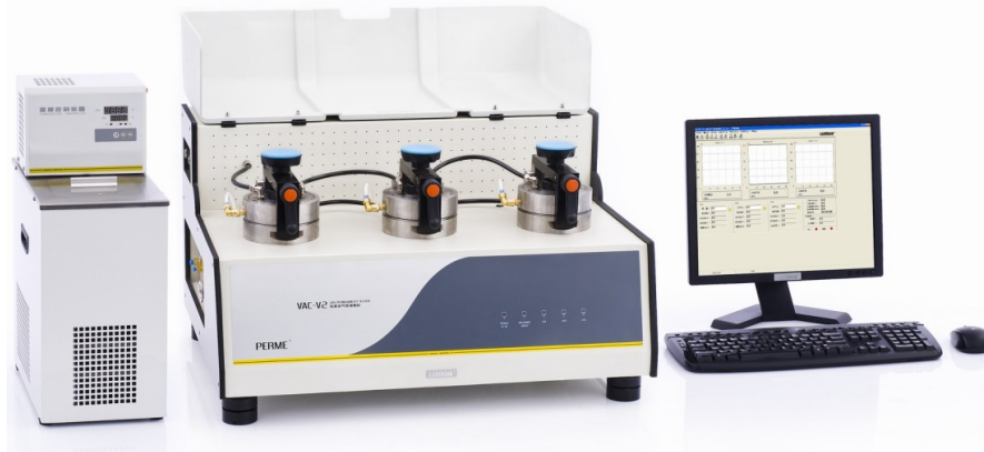
图 2 VAC-V2 压差法气体渗透仪
