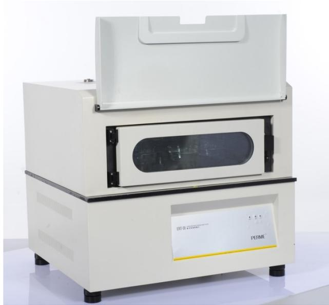
图 2 ERT-01 蒸发残渣恒重仪
