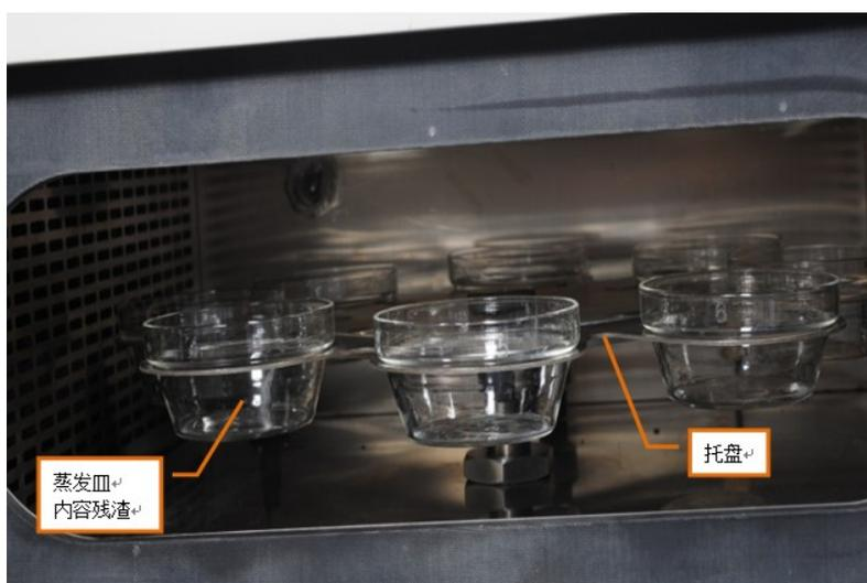
图 3 蒸发皿在 ERT-01 中的干燥过程
