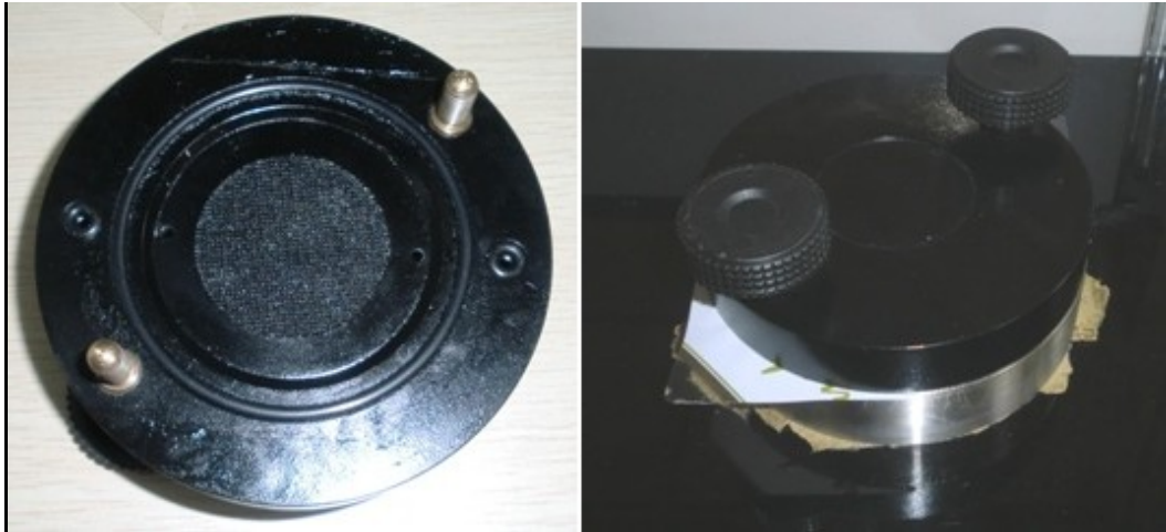
b. 放上样品后，盖上透气盖，紧固密封
