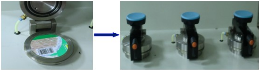
图 2 试样装夹过程
