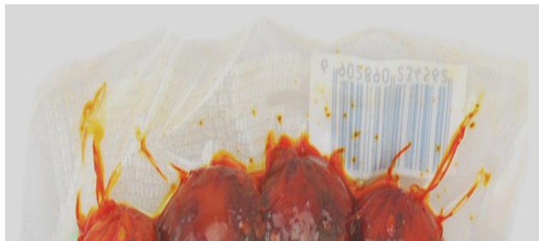
图 1 热封口轻微渗油现象
