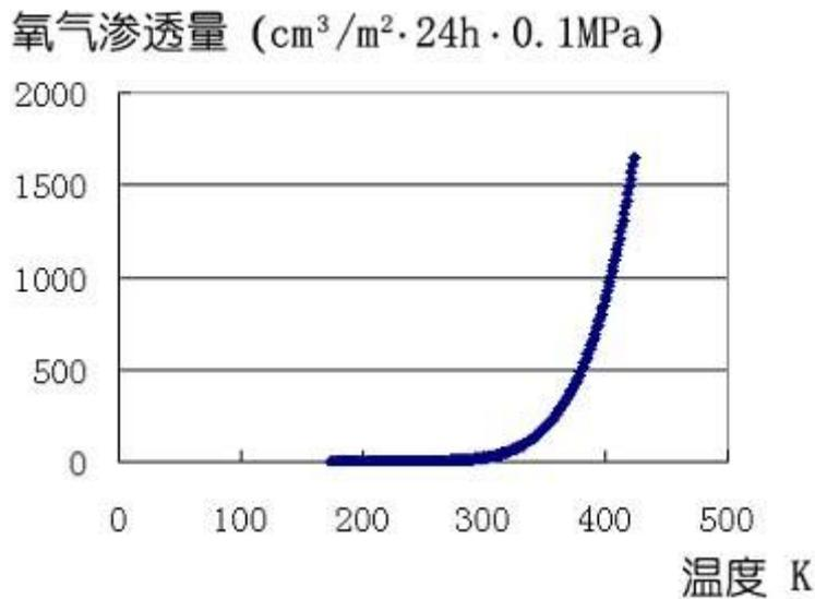
图 1. 薄膜 A 氧气渗透量与温度的曲线
