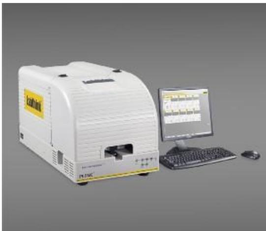
另外, 的 W3/330 水蒸气透过率测试系统采用了三个测试腔一体集成块的专利技术, 计算机控制, 全自动测试, 装夹试样后, 点击试验即可全自动试验, 自动实现湿度、温度、流速等指标的控制, 实验结束自动判断并出具报告。该仪器还可以连接 9 台卫星机, 一次完成 30 个试样的测试(氧气或水蒸气), 无论是在操作的自动化程度方面、测试的效率、检测分辨率与检测下限方面都达到了国际先进水平, 而且不少指标仍保持着领先。
